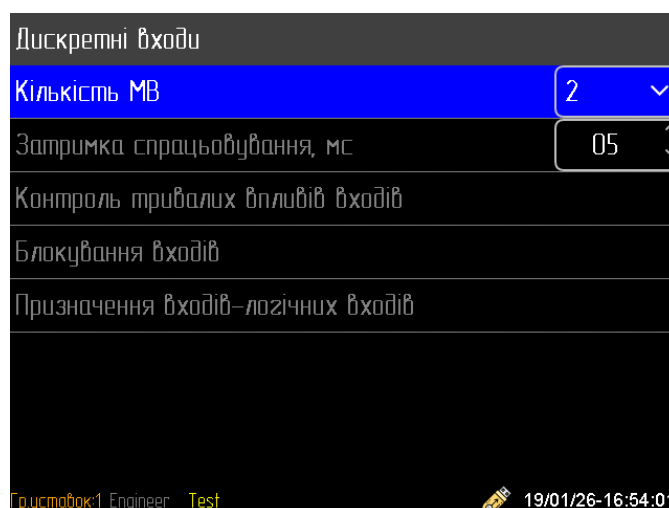
Рисунок 5.4.8.1 – Меню керування дискретними входами
