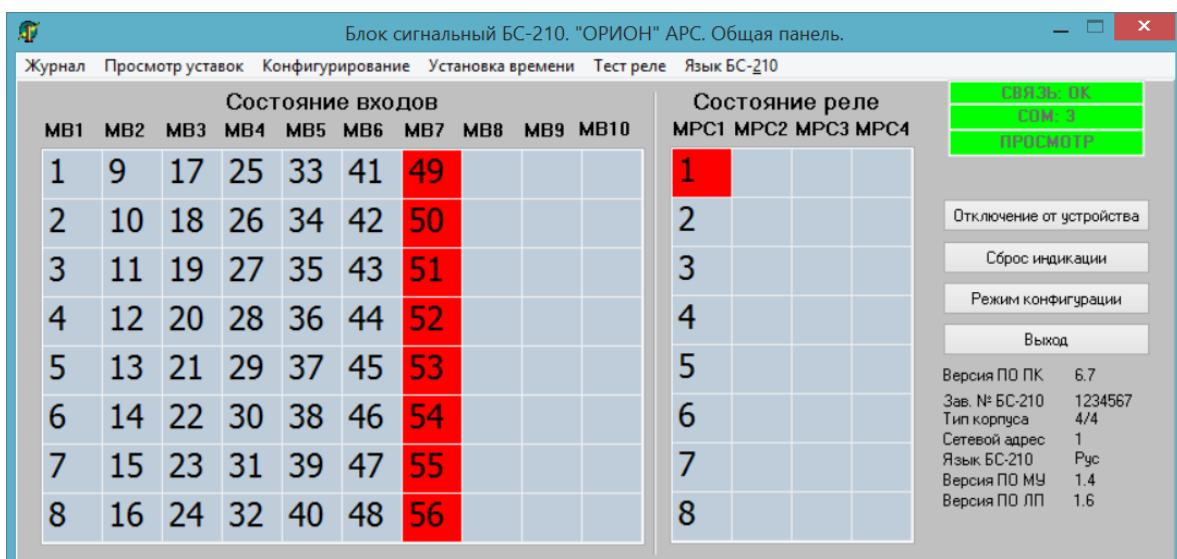
Рисунок 7 – Общая панель «UPC210» с активным подключением к устройству в режиме работы «Просмотр»
