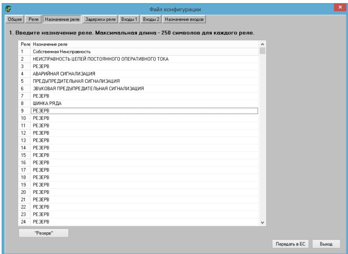
Рисунок 13 – Окно «Назначение реле» с возможностью записи в устройство (кнопка «Передать в БС»)
