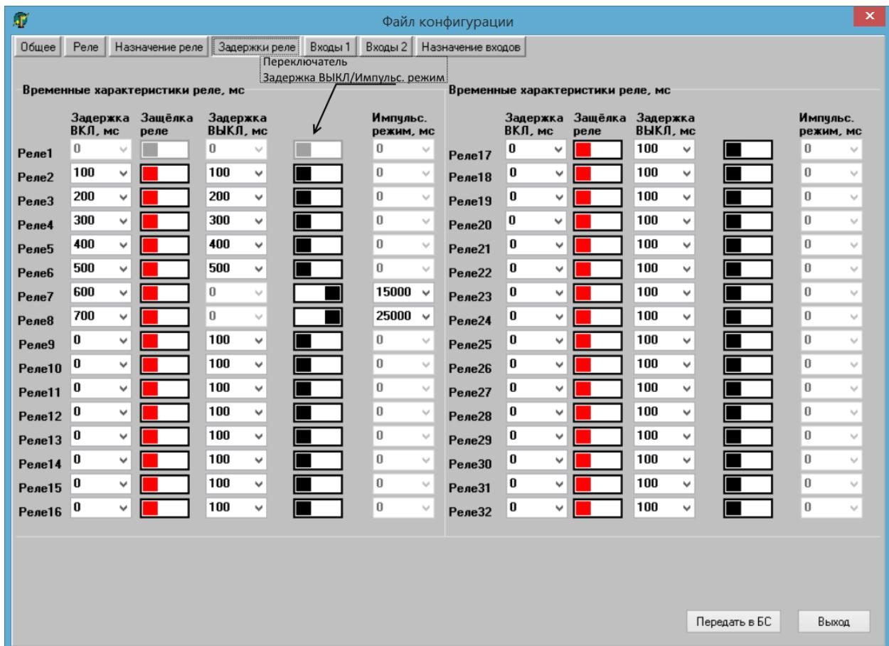
Рисунок 12 – Окно «Задержки реле» с возможностью записи в устройство (кнопка «Передать в БС»)
