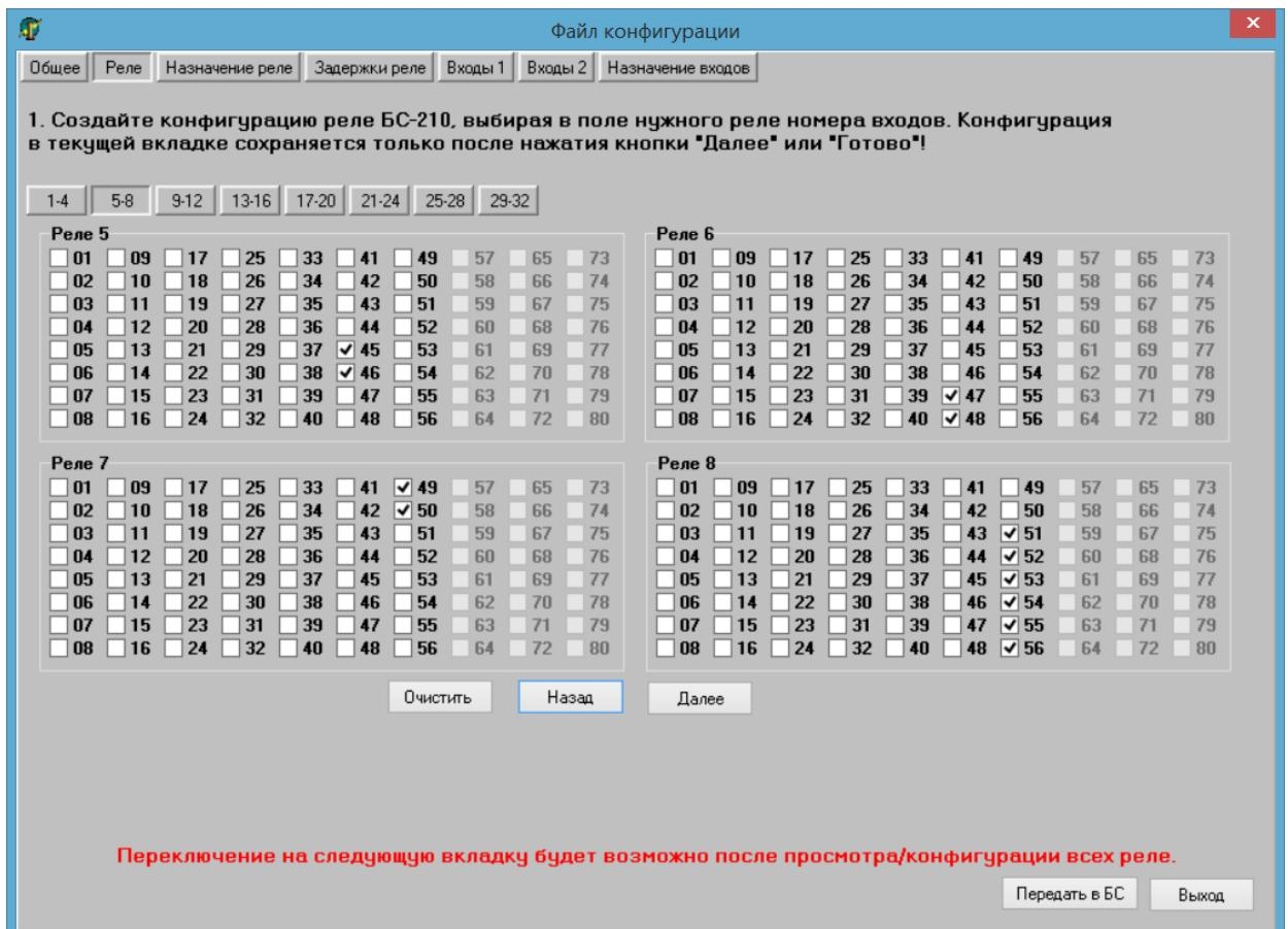
Рисунок 11 – Окно «Реле» с возможностью записи в устройство (кнопка «Передать в БС»)
