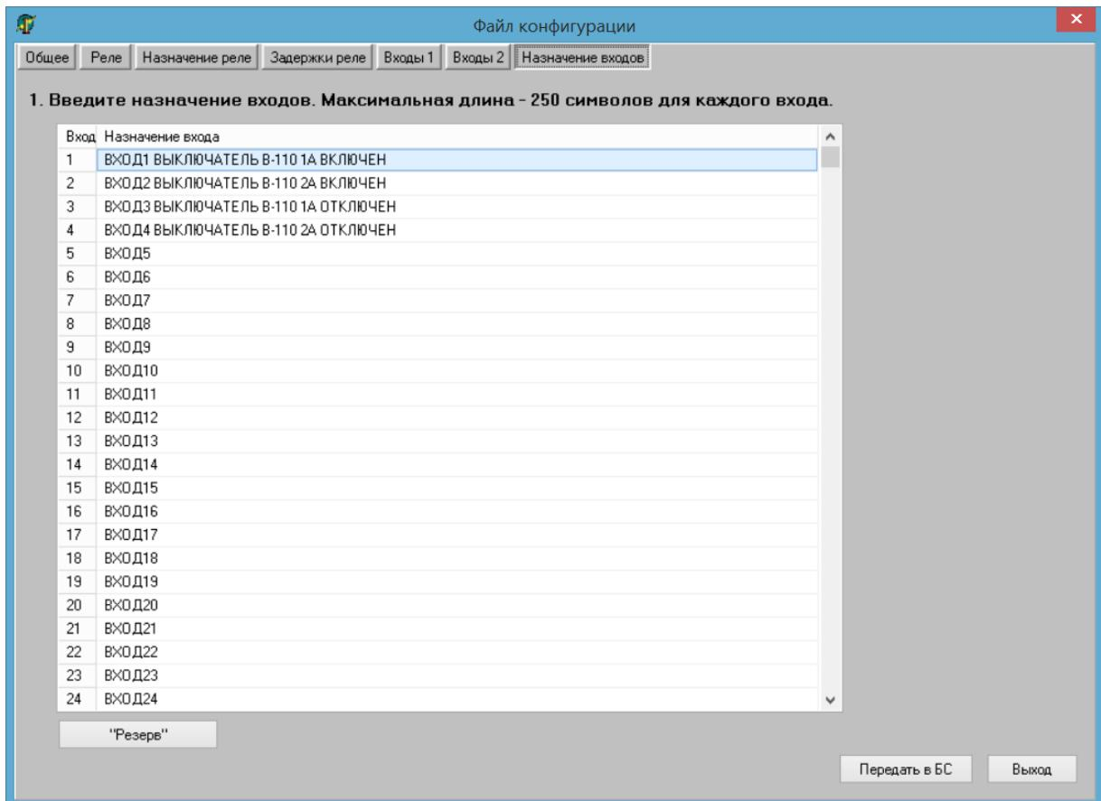
Рисунок 16 – Окно «Назначение входов» с возможностью записи в устройство (кнопка «Передать в БС»)
