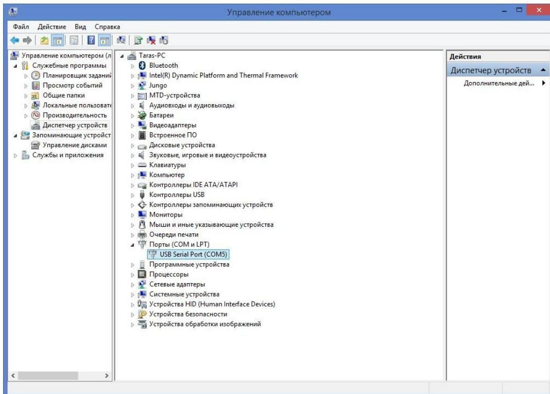
Рисунок 1 – Подключенное устройство APC отображающееся как USB Serial Port (в данном случае COM5)
