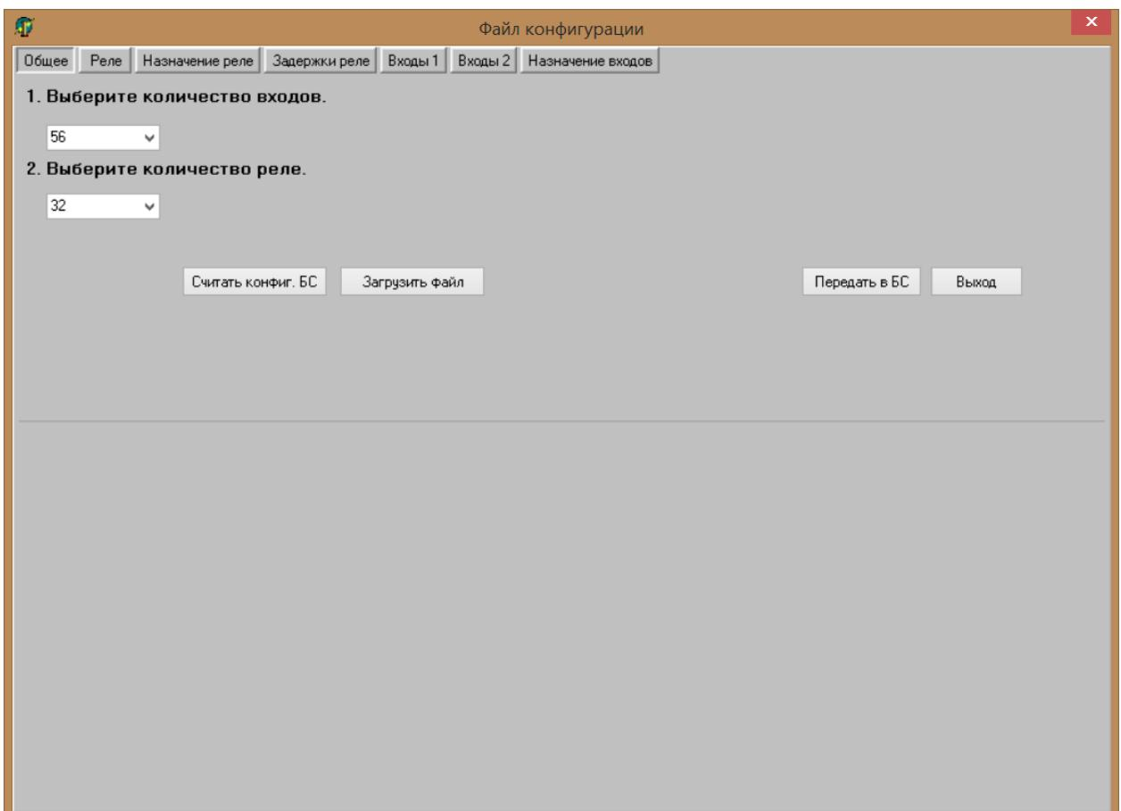
Рисунок 10 – Окно «Общее конфигурирование» с возможностью записи в устройство (кнопка «Передать в БС»)
