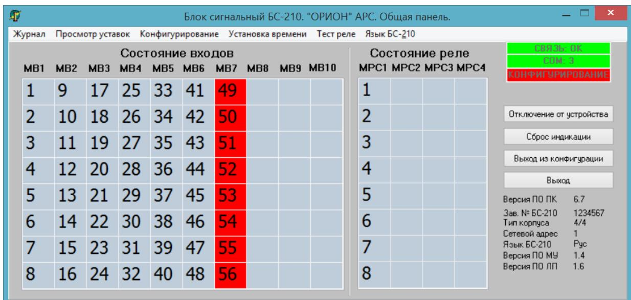
Рисунок 9 – Общая панель «UPC210» с активным подключением к устройству в режиме работы «Конфигурирование»
